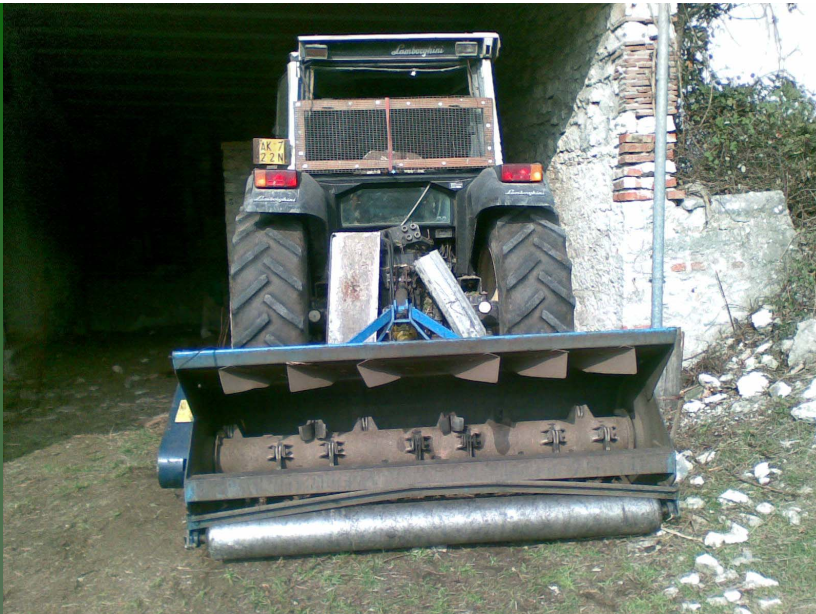
Trattrice agricola con trinciatrice portata meccanica "leggera" utilizzata nell'area di intervento di monte Vallemontagnana
